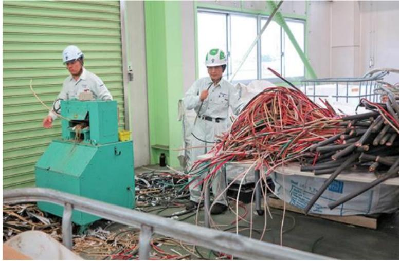
圖 2-1-3 廢電線經過機器加工抽取銅絲回收
