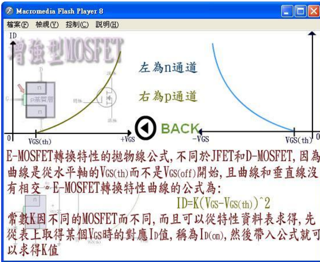
圖 3-41 E-MOSFET 的特性曲線說明圖
